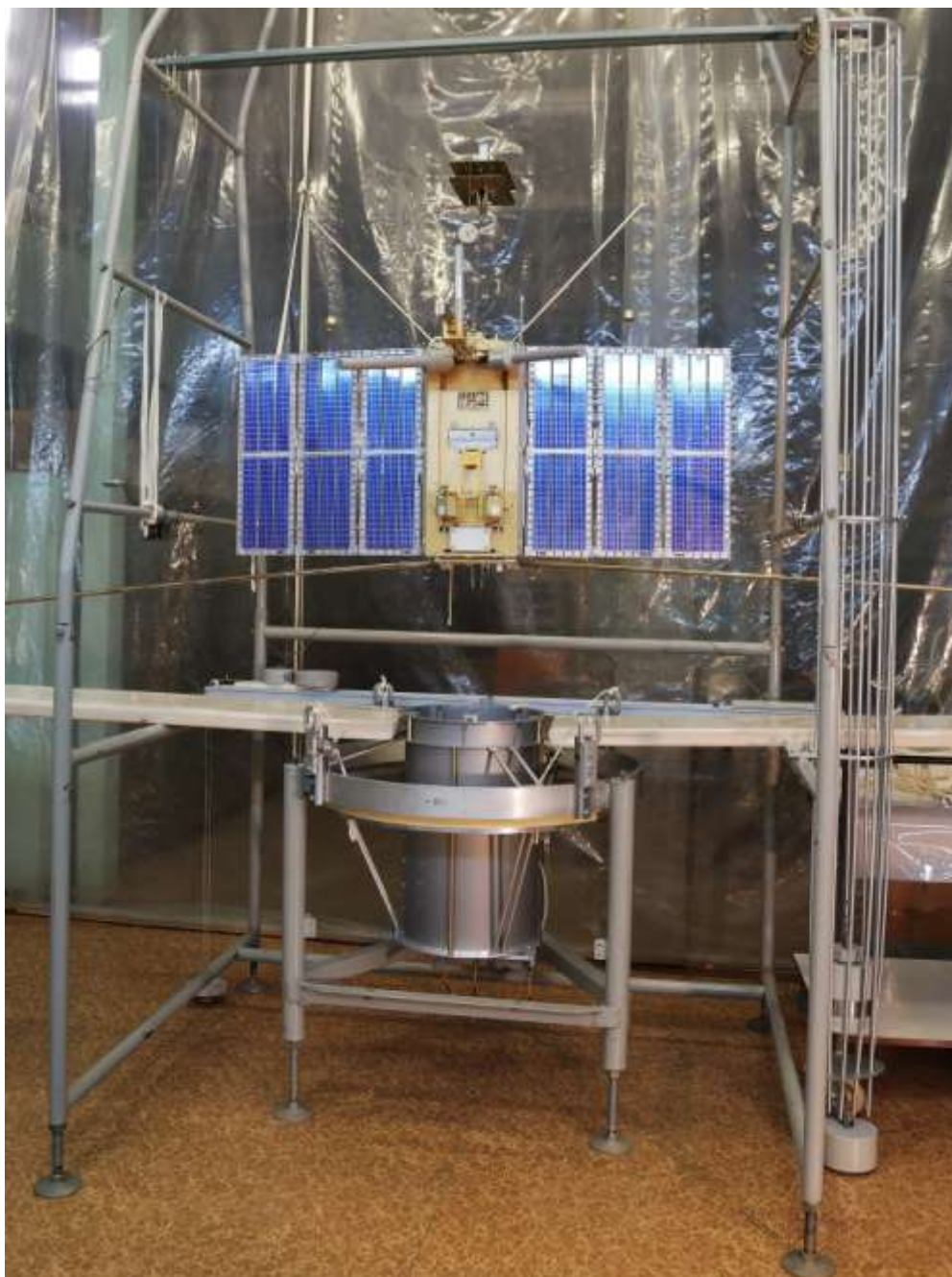
Рисунок 17. Стенд вертикального обезвешивания для имитации выхода МС «Чибис-М» из транспортно-пускового контейнера (цилиндр внизу, крепящийся на кольце, имитирующем верхний люк ТК «Прогресс-М»). СКБ КП ИКИ РАН (г. Таруса).
