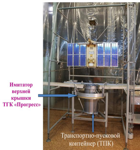
Рис. 4. Общий вид стенда вертикального обезвешивания МС
