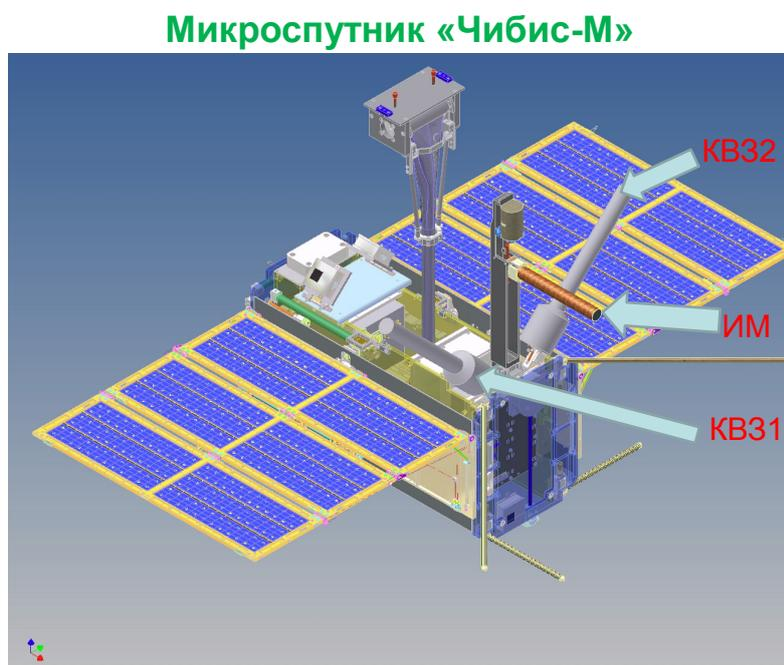
Рис. 2. Общий вид микроспутника «Чибис-М», гравитационная штанга в сложенном положении. Схема размещения комплекса МВК (см. далее)
