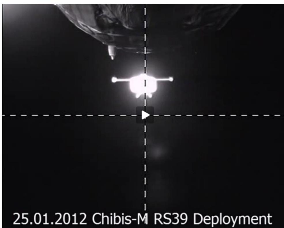
Рис. 10. Фиксация раскрытия всех механических систем МС «Чибис-М»
